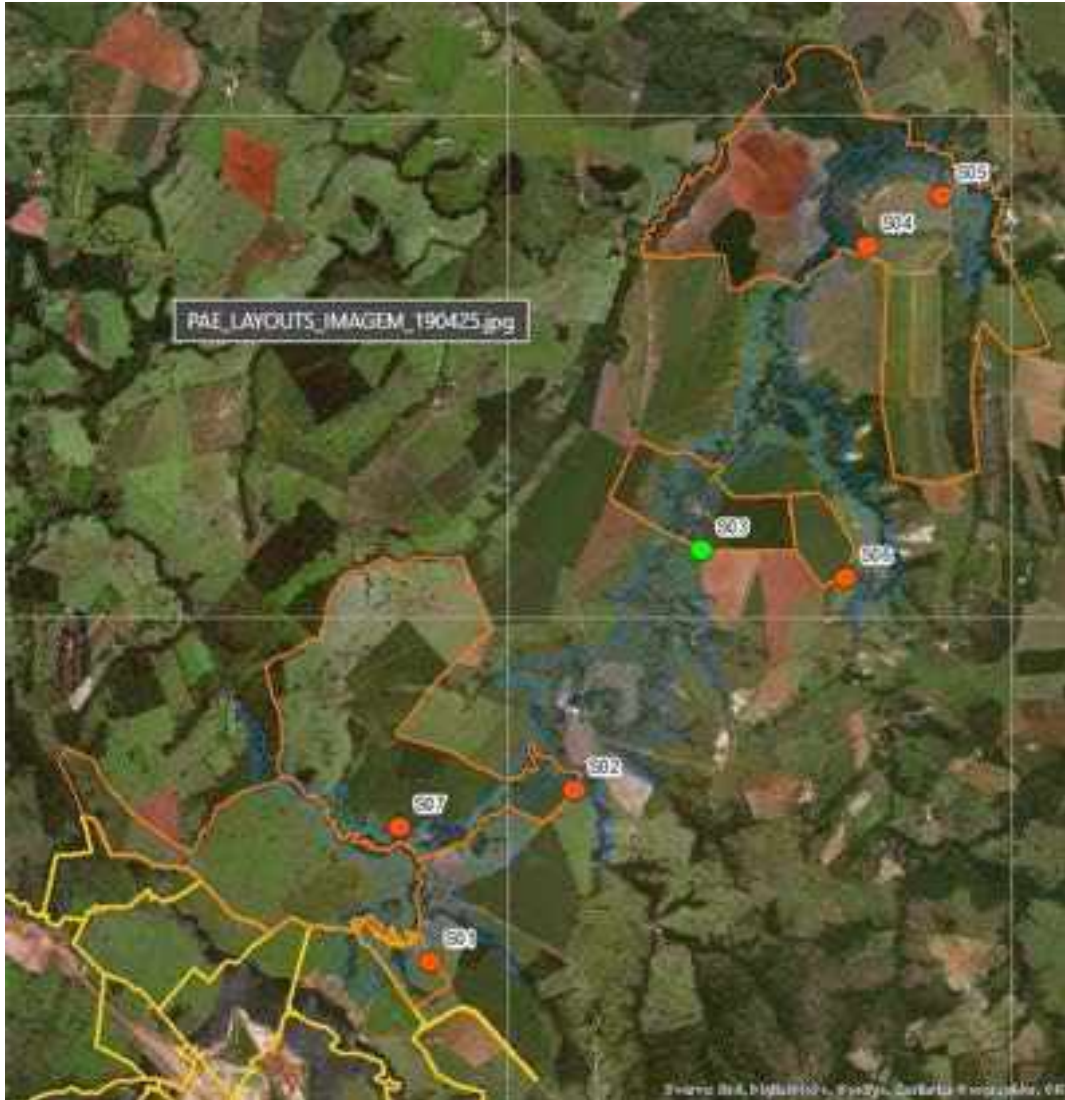
Figura 5. Localização das sirenes em relação à mancha de inundação da estrutura (pontos em verde e vermelho)
